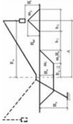
Схема поздовжньої розробки дригуну в котловані НС
